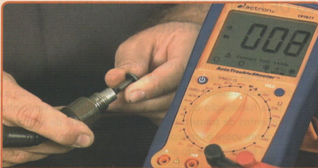
Medição do sensor de detecção de travamento do diferencial traseiro
